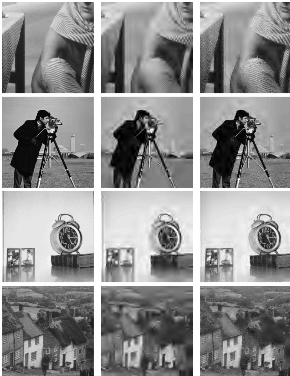
Abbildung 4.5: (Links) Originalbild; (Mitte) 9/7-Tensorprodukt-Wavelet-Transformation mit 500 von Null verschiedenen Waveletkoeffizienten (Nnu); (Rechts) Hybridmethode mit 500 von Null verschiedenen Waveletkoeffizienten.
