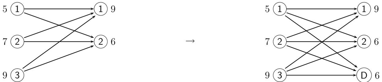
Abbildung 6.2: Einführung eines Dummy-Empfängers
